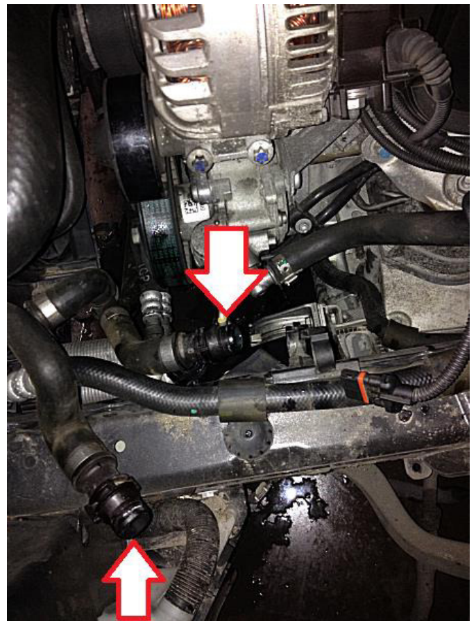
abgesteckte Leitungen der Zusatzwasserpumpe im vorderen Motorraum, gemäß BMW EBA
