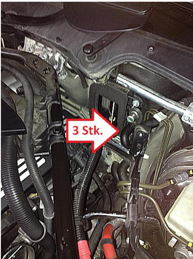
nun zugängliche Anschlüsse am Heizkörper an der Stirnwand
