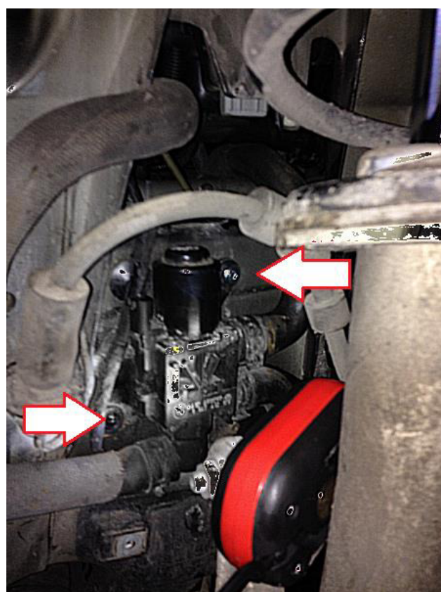
montiertes Umschalt-/Absperrventil (2x M6 Muttern)
